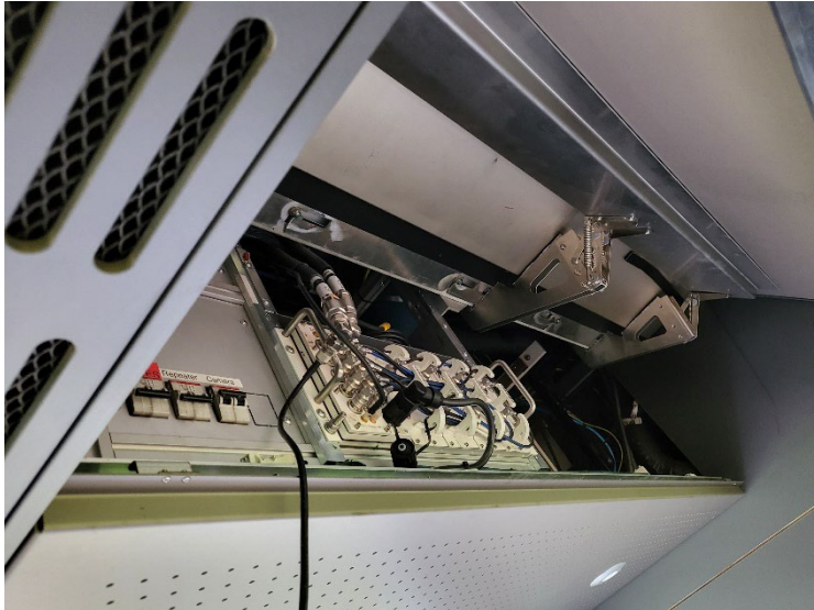
Figur 1 Inkoppling Skanner Öresundståg, ej GPS
